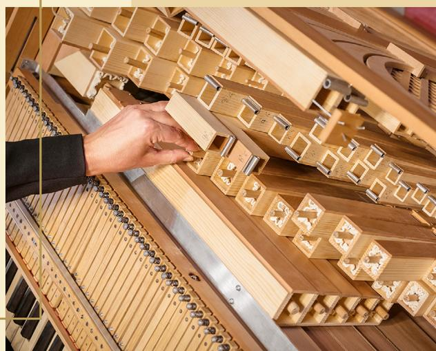
Durch einfach herausnehmbare Seitenteile sind die Stimmeinrichtungen direkt und OHNE Entfernen von Pfeifen oder anderen Bauteilen zugänglich. Große Beschriftungen erleichtern die Nachstimmung.
