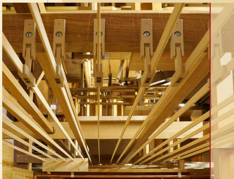
Die Wiederherstellung der Disposition und der den barocken Klang-Intentionen entsprechende Windverbrauch, die nahezu ausschließliche Verwendung von Holz, Leder und Stahl der zu fertigenden Traktur, erforderte Anstrengungen, die an die Grenze des Machbaren gingen.
